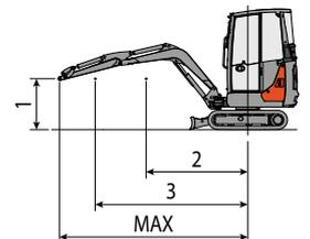
Hebekraft basierend auf ISO-Norm 10567 und überschreitet nicht mehr als 75% der Kipplast oder 87% der hydraulischen Hebe-Kapazität der Maschine.
